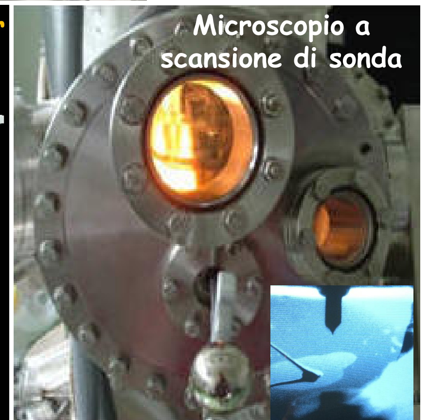
Criostato per misure a 10 mK
