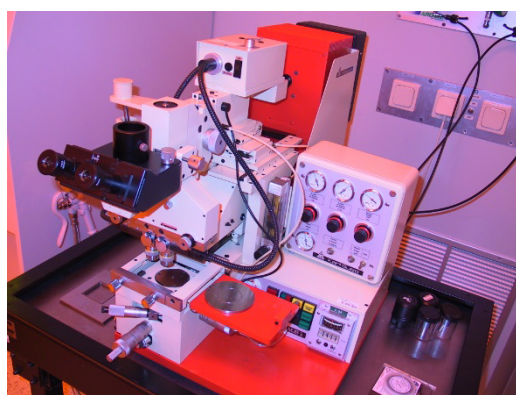
Mask aligner: allinea manualmente la maschera al substrato
